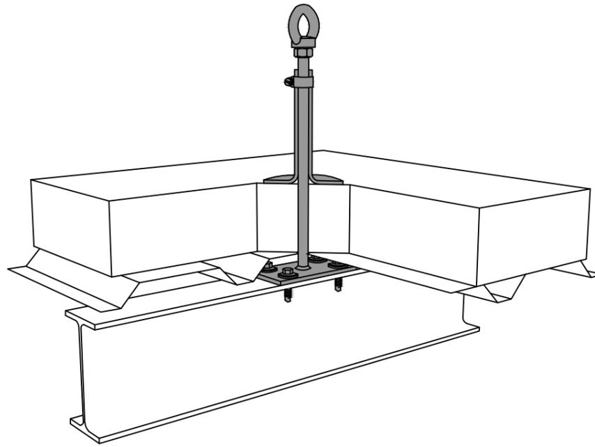
ANCLAJE PARA ESTRUCTURA METÁLICA
